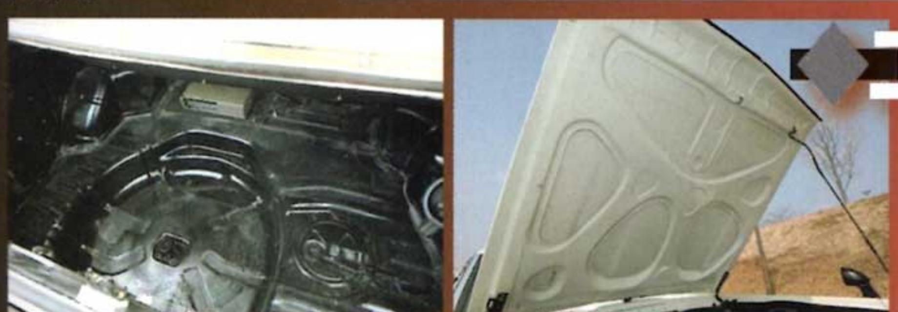
ボンネットはFRP製、ケンメリ用ヒンジ等を加工して取り付けている。トランクルームを見ると骨格がR32だと言うのが分かる
