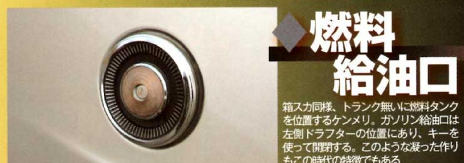
箱入り同様、トランク無しに燃料タンクを位置するケンメリ。ガソリン給油口は左側ドラフターの位置にあり、キーを使って開閉する。このような凝った作りもこの時代の特徴である
