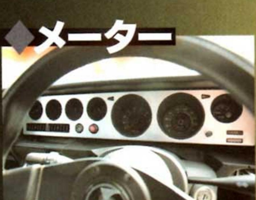
ケンメリ特有の7連メーターにGT-R仕様のアルミパネルを備えるメーター回り。RB25エンジン搭載なのでオートエアコン（助手席下にユニットを隠している）、油圧パワステを装着し、スイッチ類も床下に見える
